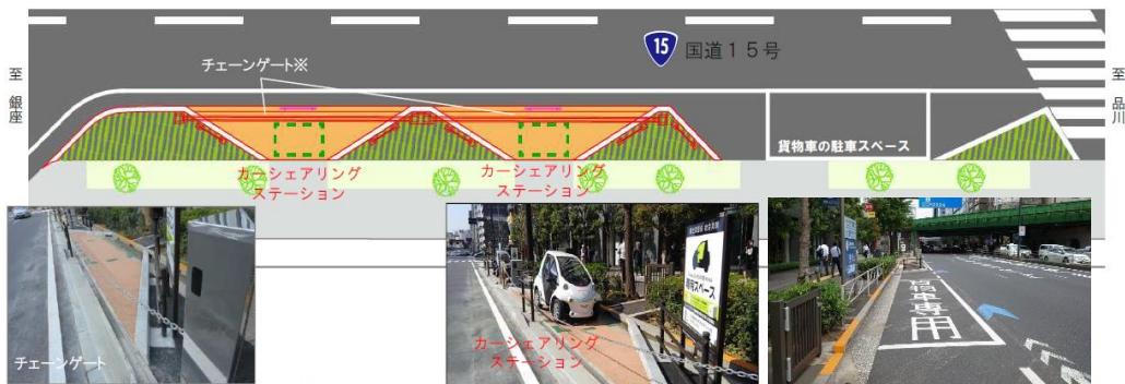
カーブサイドを活用したカーシェアリングステーション例（国道15号）
