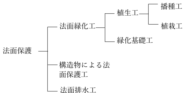
図 3-54 法面保護工の分類
