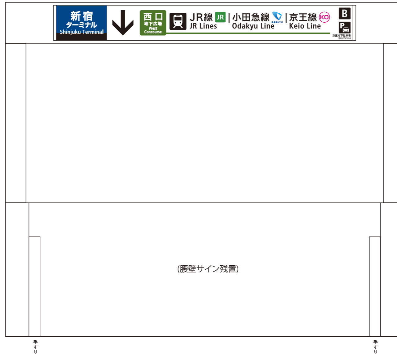
西-1001<片面> 器具寸法H300×W2580 表示面寸法H300×W2530 (和文文字高80,72,20)
