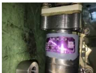
主翼可動部の識別プレート (大きさ 6cm×2.5cm、重量10g)
