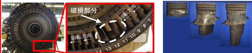
一部ブレードが破損したエンジン 一部が破損したブレード
