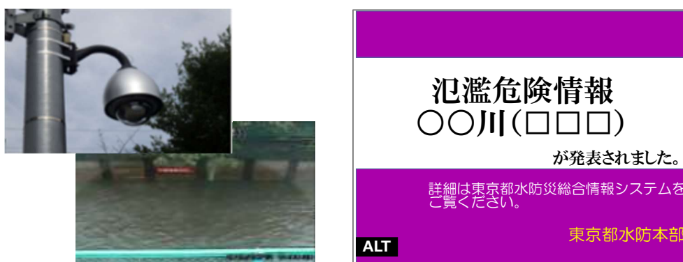
図 4-33 河川監視カメラ等観測機器の設置及びX（旧 Twitter）を用いて氾濫危険情報（水位周知河川）をポストするイメージ
