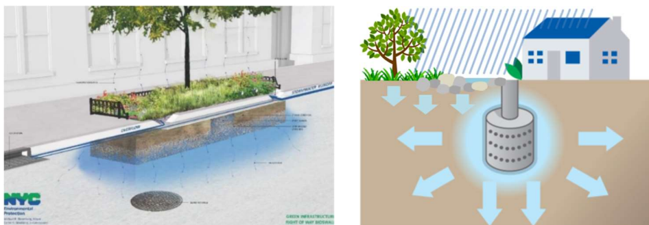
図 4-31 雨水流出抑制に資するグリーンインフラのイメージ
