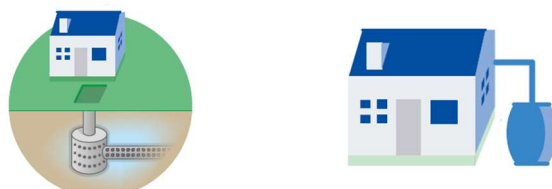
図 4-23 雨水浸透ます（左）と雨水タンク（右）
