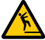
転落注意 Caution, drop 【注1】(文字による補助表示が必要)
