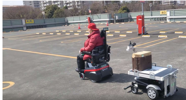
自動車椅子の自動運転の後を自動運搬ロボットが自動追従
