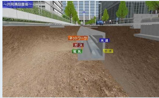
地下・共同溝設置後
