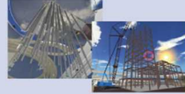
施工シミュレーション・無人化施工
