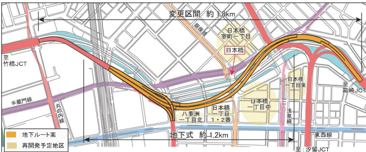
平面図（地下ルート案：第 3 回首都高日本橋地下化検討会（2018 年 7 月 18 日）資料より作成
