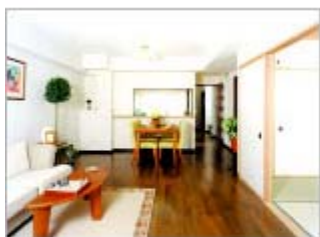
段差のない和室入り口・広いドア幅
