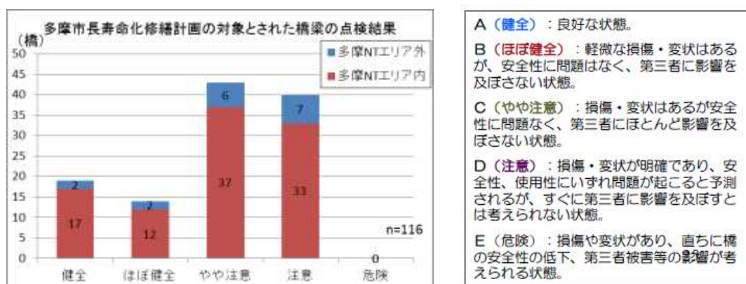
図表2-35 多摩ニュータウン（多摩市域）の橋梁 りょう の老朽化の状況
